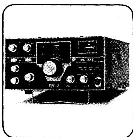
**IC-210**は本格派固定用機としてフェーズロック方式を採用し、ゆとりある設計がなされています。その素晴らしい技術と豊富な付属回路を満喫して頂くため以下の事項は必ずお守りください。
